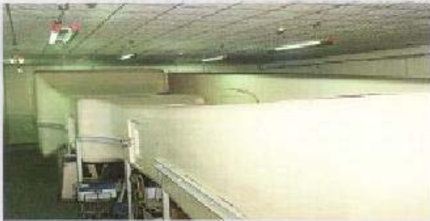
風速校定装置（大風洞） The calibrating device for wind speed instruments (wind tunnel)
